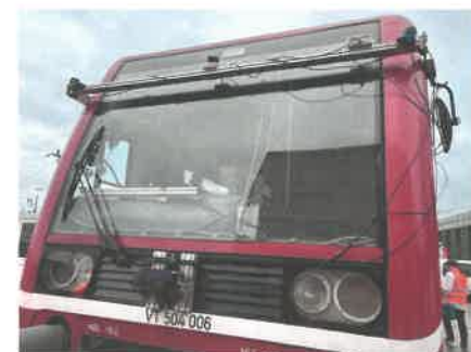
Das Sensorsystem mit zwei Lidar (oben mittig und unten mittig) sowie Kameras (hinter Glas)
