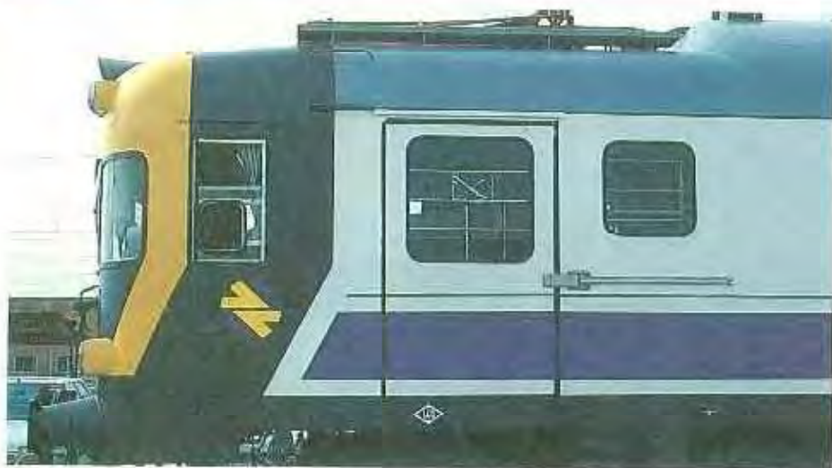
Se ha sustituido la puerta de paquetería por otra deslizante.
