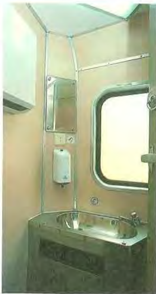
Los aseos son de nuevo diseño, sustituyéndose el lavabo y el inodoro por otros de acero inoxidable.
