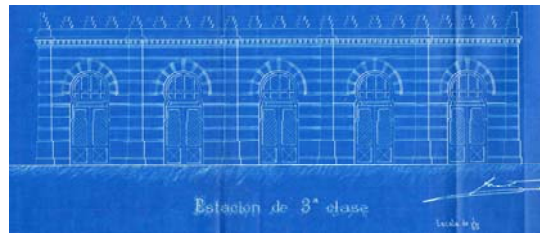
Alzado estación de 3ª clase línea de Sevilla a Huelva. Fuente: AHF B-0034-004-004
