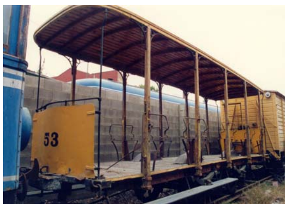
FIG. 11 y 12- Tranvía de Caballos SVT 12 antes y después de su restauración. CONSTRUCTOR: The Bristol Wagon & Carriage Works Co. Ltd. Bristol (Inglaterra). AÑO CONSTRUCCIÓN: 1890. MEDIDAS: Longitud 6800 mm, Anchura 1950 mm, Altura 2900 mm. PESO: 2500 kg. ANCHO DE VÍA: 1000 mm. Tranvías de Valencia.
