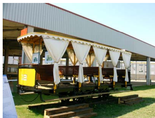
FIG. 11 y 12- Tranvía de Caballos SVT 12 antes y después de su restauración. CONSTRUCTOR: The Bristol Wagon & Carriage Works Co. Ltd. Bristol (Inglaterra). AÑO CONSTRUCCIÓN: 1890. MEDIDAS: Longitud 6800 mm, Anchura 1950 mm, Altura 2900 mm. PESO: 2500 kg. ANCHO DE VÍA: 1000 mm. Tranvías de Valencia.
