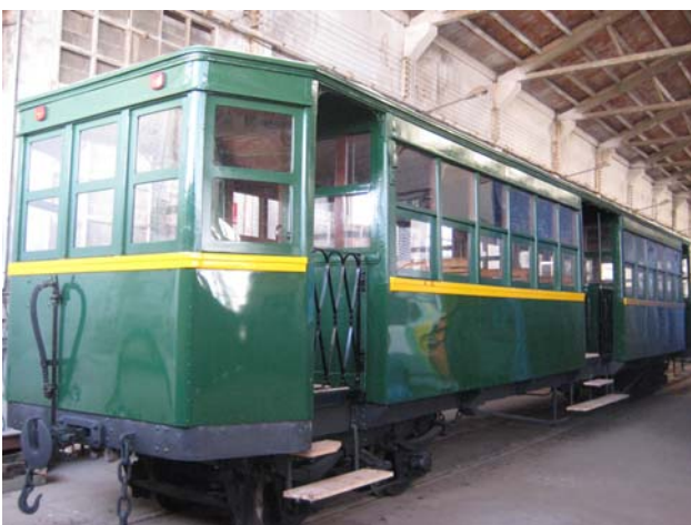
FIG.9 y 10- Exterior e interior del Coche remolque 53 / Fot. Nelo Cerdà. CONSTRUCTOR: Carde y Escoriaza (Zaragoza). AÑO CONSTRUCCIÓN: 1922. MEDIDAS: Longitud 13500 mm, Anchura 2500 mm, Altura 2600 mm. (caja). PESO: 12500 kg. ANCHO DE VÍA: 1000 mm.
