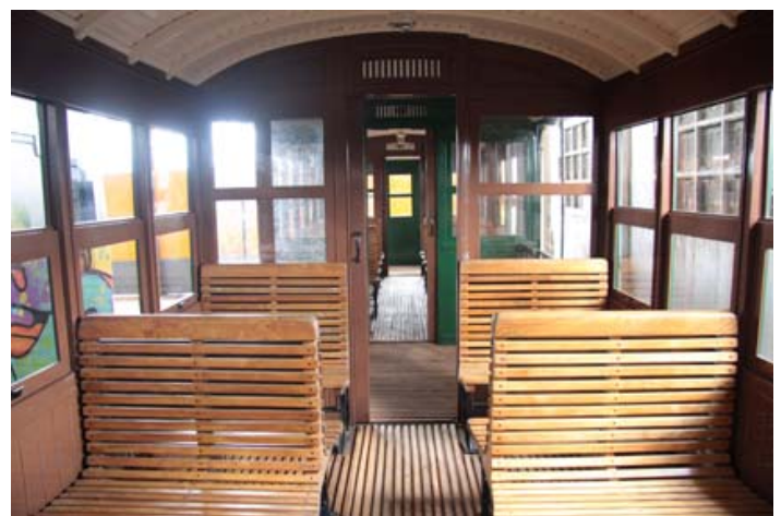
FIG.9 y 10- Exterior e interior del Coche remolque 53 / Fot. Nelo Cerdà. CONSTRUCTOR: Carde y Escoriaza (Zaragoza). AÑO CONSTRUCCIÓN: 1922. MEDIDAS: Longitud 13500 mm, Anchura 2500 mm, Altura 2600 mm. (caja). PESO: 12500 kg. ANCHO DE VÍA: 1000 mm.
